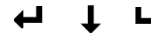
Vanne à 3 voies seul(e) le sens du courant / la position de commutation de la vanne est indiqué(e).
