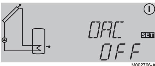
Lorsque la température du capteur est inférieure à la température **TAON**, la fonction antigel active la pompe solaire, afin de faire circuler le liquide caloporteur entre le capteur et le préparateur, pour l'empêcher de geler. Lorsque la température du capteur dépasse la température **TAOF**, la fonction antigel arrête la pompe solaire.
