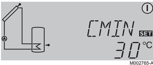
La fonction température minimale du capteur **CMIN** empêche la pompe solaire de se mettre en marche trop fréquemment en cas de températures basses du capteur solaire. La température minimale du capteur **CMIN** doit être dépassée pour que le circulateur solaire puisse se mettre en marche.
