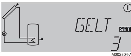
Le paramètre **GELT** permet de régler le type d'antigel utilisé. La valeur de concentration d'antigel est pré-réglée pour une utilisation des produits Tyfocor LS / G-LS et Greenway. En cas d'utilisation d'un autre antigel, sélectionner les valeurs de réglage **1** ou **2**, puis régler le paramètre **GEL%**. Voir chapitre : "Liste des paramètres", page 62.
