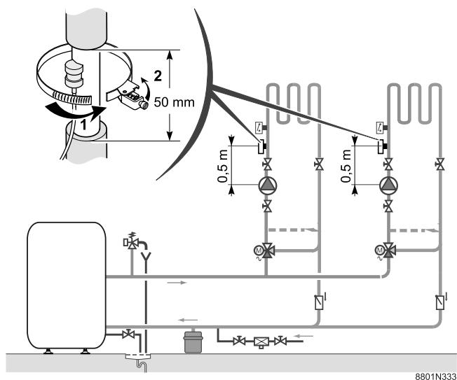
带有连接线(长2.5米)和连接插头的水温探头，要安装在相关的循环的出口管上，并与控制器上预置的插口连接(如图所示)。
