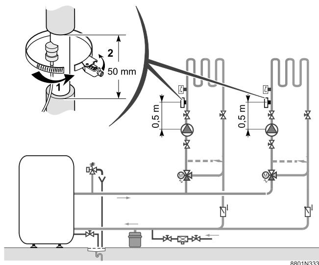
La sonde de départ avec câble de raccordement (longueur 2.5 m) et fiche de connexion est à monter sur la tubulure de départ du circuit concerné et doit être raccordée à l'emplacement prévu dans le tableau de commande indiqué ci-après.
