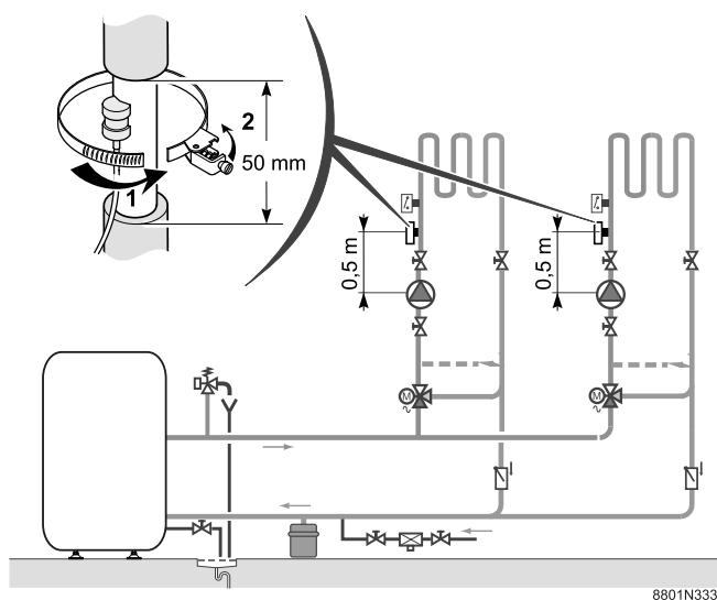
A sonda de ida, com o cabo de ligação (com 2.5 de comprimento) e a respectiva ficha, deve ser montada no bocal de ida do circuito e deve ser ligada ao dispositivo previsto no painel de controlo a seguir indicado.
