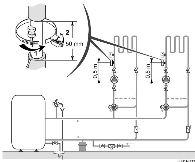
Čidlo náběhové vody s připojovacím kabelem (délka 2.5 m) se připevní na potrubí náběhové vody odpovídajícího okruhu a musí být připojeno pomocí dodaného konektoru dle následujícího postupu.
