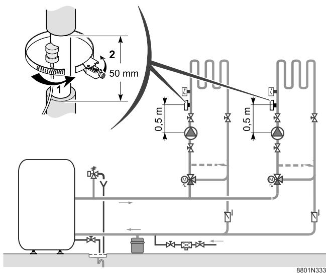
De voeler van de vertrekleiding met aansluitkabel (lengte 2.5 m) en aansluitstekker moet op de vertrekbuizen van de kring gemonteerd worden en aangesloten worden op het printplaat van de bijbehorende kraan, zoals aangegeven inde handleiding van de bedieningsbord.
