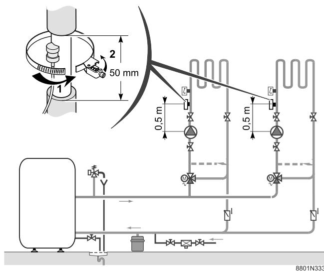
Датчик температуры подающей линии с соединительным кабелем (длиной 2.5 м) и разъемом для подключения устанавливается на подающем трубопроводе данного контура и должен быть подключен на предусмотренный разъем панели управления как описано ниже.
