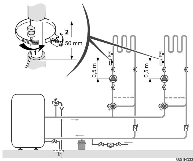
La sonda di mandata con cavo di collegamento (lunghezza 2.5 m) e spina di connessione va montata sul tubo di mandata del circuito interessato, e dev'essere connessa alla posizione prevista nel pannello di comando come indicato qui di seguito.
